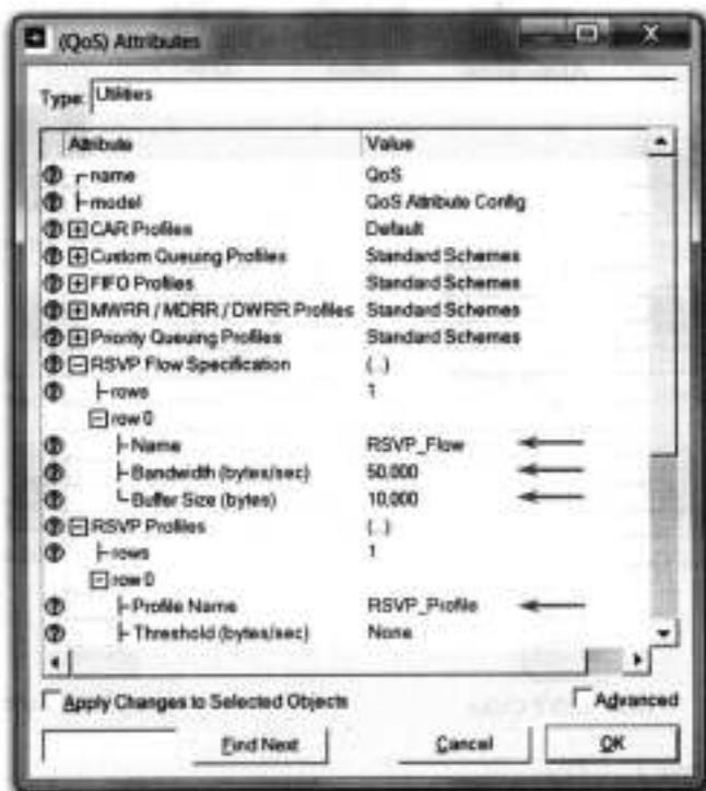
**有益提示** RSVP 流 (RSVP Flow) 定义了 RSVP 试图预留的流量需求 (带宽和所请求的缓冲区大小)。
