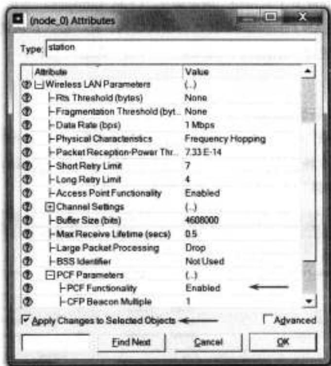
4) 在节点 node\_0 上右击→“编辑属性”(Edit Attributes)→展开“无线局域网参数”(Wireless LAN Parameters)的层次结构,把“接入点功能”(Access Point Functionality)设置为“有效的”(Enabled)→单击“确定”(OK)。
