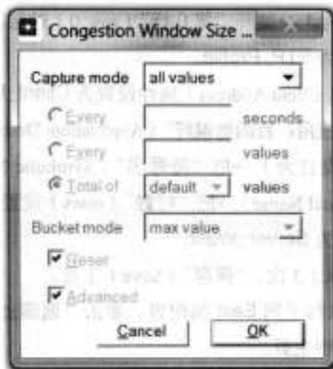
b. 在“拥塞窗口大小(字节)”(Congestion Window Size(bytes)) 统计量上右击→选择“改变收集模式”(Change Collection Mode)→在对话框中, 选择“高级”(Advanced)→从下拉菜单中把“捕捉模式”(Capture mode) 设置为“所有值”(all
