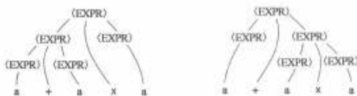
图 2-3 字符串 a+a \times a 在文法 G_1 中的两棵语法分析树
