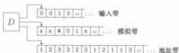
图 3-7 确定型图灵机 D 模拟非确定型图灵机 N
