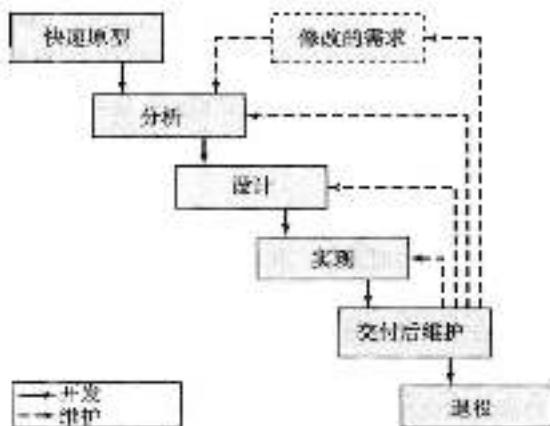
图2-10 快速原型开发生命周期模型
