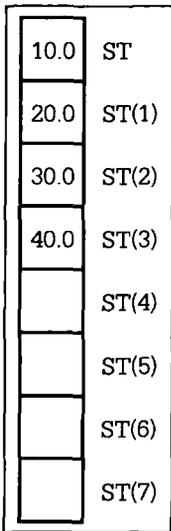
下图左显示了指令 `fist intValue` 执行后的堆栈情况，下图右显示了指令 `fistp intValue` 执行后的堆栈情况。在这两种情况下，`intValue` 中的值都是 `0000000A`，这是浮点数 10.0 的双字长二进制补码的整型表示。
