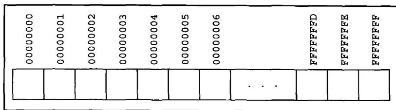
图 1-2 PC 存储器的逻辑图
