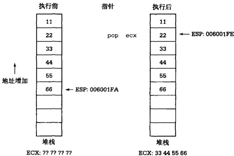
`push` 和 `pop` 指令的一个用途是将寄存器中的内容暂时存放在堆栈中。前面已经提到，在编程时，寄存器是稀缺资源。例如，假定寄存器 EDX 已用来存储某些程序变量，但是在进行除法运算时，被除数必须先扩展存放在 EDX: EAX 中，为了避免丢失 EDX 中存储的数据值，必
